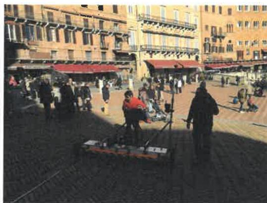
Prospezioni geofisiche condotte con geo-radar (GPR) in diverse situazioni con apparecchiatura GPR 3 - Stream-X sviluppata e prodotta dall'azienda italiana Ingegneria dei Sistemi di Pisa.
